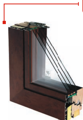
Ultratherm Ultima L'épaisseur du profilé de 122 mm / 125 mm, Uw à partir 0,67 W/m²K.
