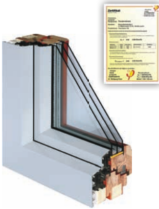
Alutrend Miratherm L'épaisseur du profilé de 126 mm, Uw à partir 0,70 W/m²K.
