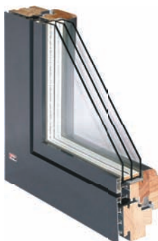
Alutrend Quadrat FB / XL / MAX Le capotage en aluminium du dormant et de l'ouvrant aligné de l'extérieur.
