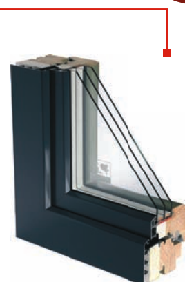
Ultratherm Classic L'épaisseur du profilé de 114 mm, Uw à partir 0,71 W/m²K.
